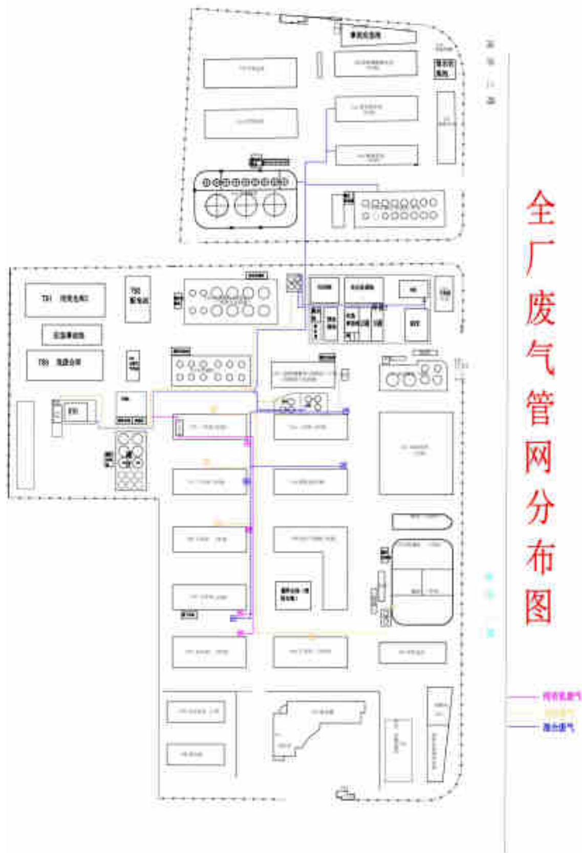
附图 8：项目厂区废气管网图
